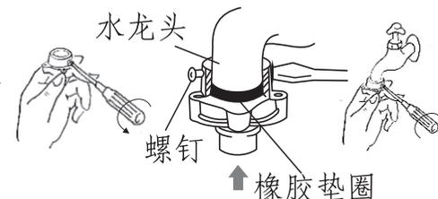
4. 将B部按箭头方向旋紧,使橡胶垫圈紧压在水龙头口上,密封不漏水为止。
