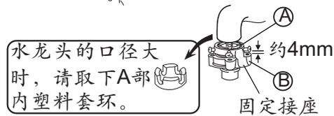
3. 旋松A部四个螺钉，将A部水平地套在水龙头口上，并用力向上推，使橡胶垫圈紧贴在水龙头口端面上，然后逐个均匀旋紧四个螺钉，保持水龙头在中心位置。
