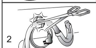
2. 小心地剪断扎紧电源线和排水软管的塑料扎带。
