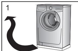
1. 拆开包装，拆掉洗衣机的包装底座并取出里面的泡沫垫块，然后把洗衣机移到需要安装的位置上。
