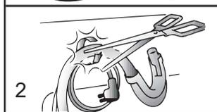
2. 小心地剪断扎紧电源线和排水软管的塑料扎带。
