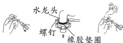
4. 将B部按箭头方向旋紧，使橡胶垫圈紧压在水龙头口上，密封不漏水为止。
