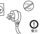
★ 使用独立三孔专用插座，并进行可靠接地。接地线不得引到电话线、水管、煤气管道及避雷针上；
