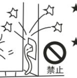
★ 不要在冰柜上部放置不稳定的物品（重物、有水的容器）以免掉下伤人或溢水导致漏电。
