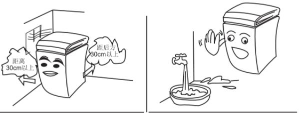
★ 放置冰柜应该远离热源并避免太阳光直射，以免影响冰柜的工作性能。
