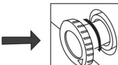
旋转放水管，使管上的箭头朝下。
