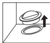
冰柜内胆底部有一个排水口，除霜时拔开水管堵头（该堵头在冰柜拆封前在附件袋中，拆封后客户自行安装），化霜水从此口流入，并从放水管排出。
