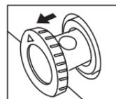
将冰柜前面的放水管拔出20-25mm直到露出放水口。
