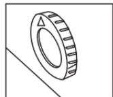
除霜完成后，先确认放水管中不在有水排出，再将放水管收回，并把箭头旋向上。
